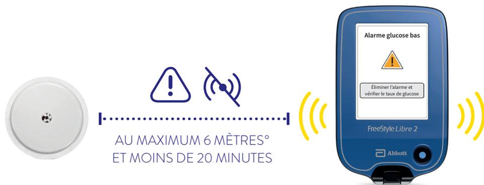
Votre lecteur peut recevoir les alarmes de glucose<sup>°</sup> jusqu'à 6 mètres de distance<sup>°</sup>. Les alarmes ne sont transmises qu'au premier appareil lié. Pour utiliser les alarmes, veuillez suivre les instructions figurant dans le manuel d'utilisation.
