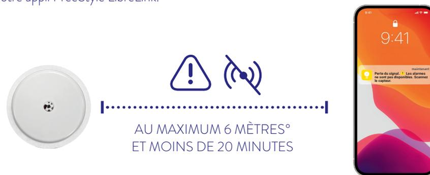
Votre smartphone peut recevoir des alarmes de glucose<sup>1</sup> jusqu'à 6 mètres de distance.<sup>9</sup> L'alarme de perte de signal est activée automatiquement dès qu'une alarme de glucose est activée pour la première fois. Vous pouvez désactiver et activer à nouveau l'alarme de perte de signal à tout moment.
